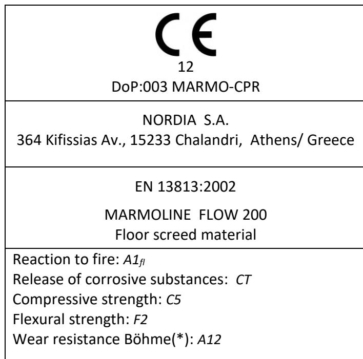
(\*): Ο προσδιορισμός της αντοχής στην απότριψη έγινε με τη μέθοδο EN 14157 (Method A, Wide wheel abrasion test). Η μετατροπή από τη μέθοδο A (wide wheel abrasion test - WWA) στη μέθοδο B (Böhme abrasion test - BA) προέκυψε από τη σχέση WWA=1,711BA+15,32 (Παράρτημα A ΣΑ.3 του EN 14157)
